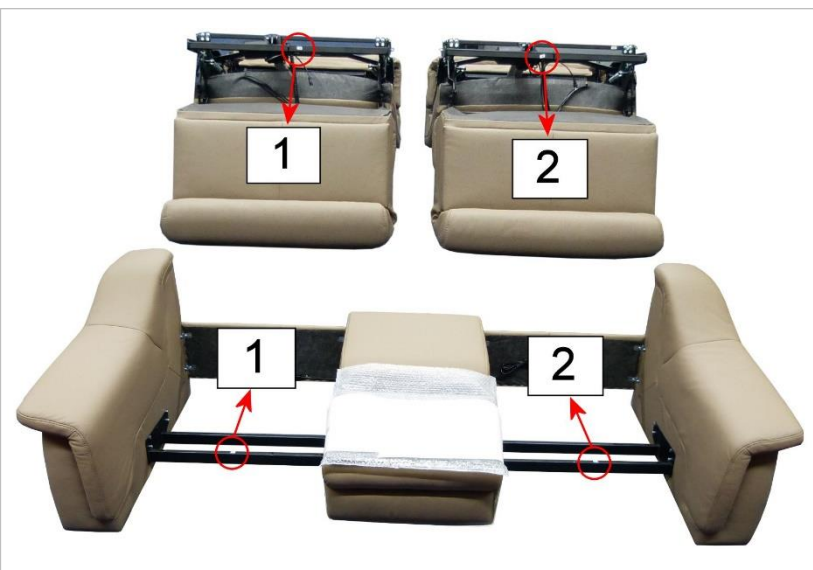
Stütz Fuß ab einer Chassis breite von 1,2 m
